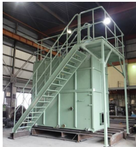
50 m 3 /min カートリッジ上部取出し構造 ( 1.5mx3.1mx2.9mH )
